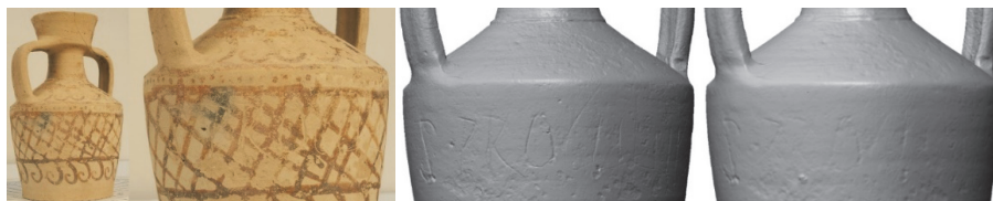
Figura 3 – Anforetta tardoantica con testo inciso e relativi modelli 3D: in basso a sinistra realizzato con laser scanner, a destra costruito con PhotoScan.
